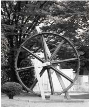
▲丸一製作所時代のドローパーベンチのメインギア 直径約1.8m
