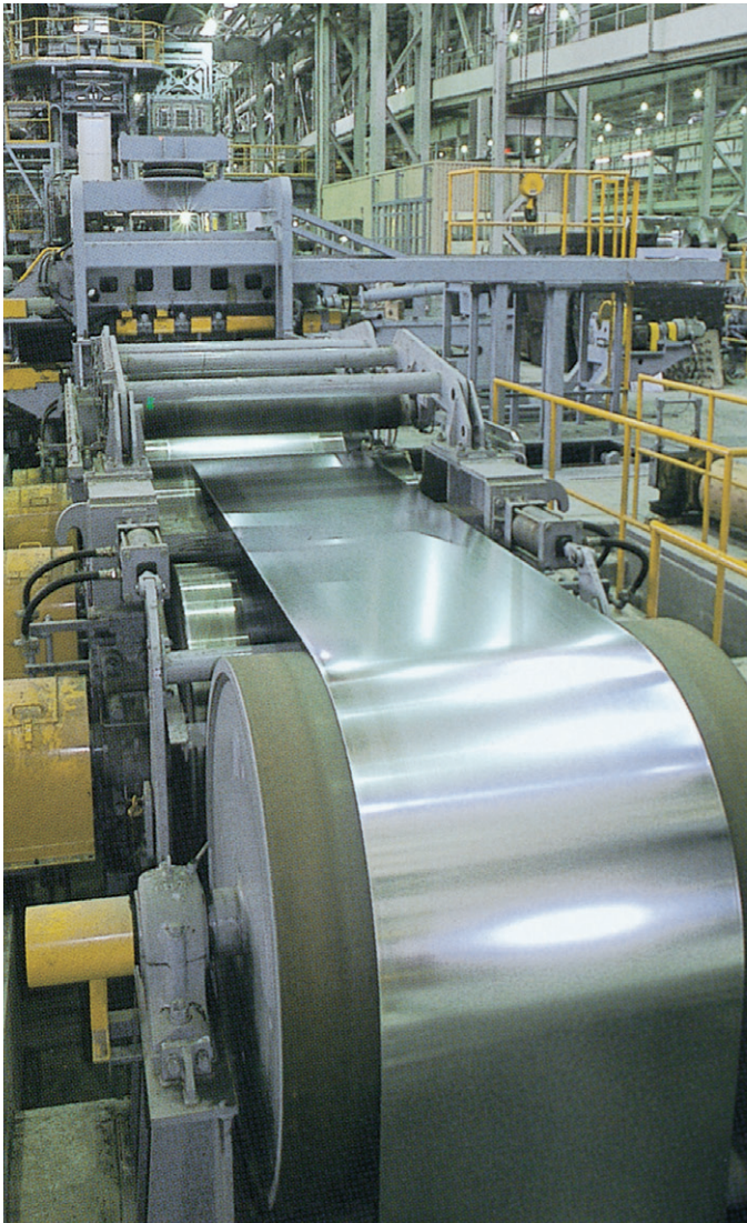
帯鋼めっきライン
